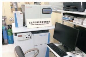
安定同位体質量分析装置
