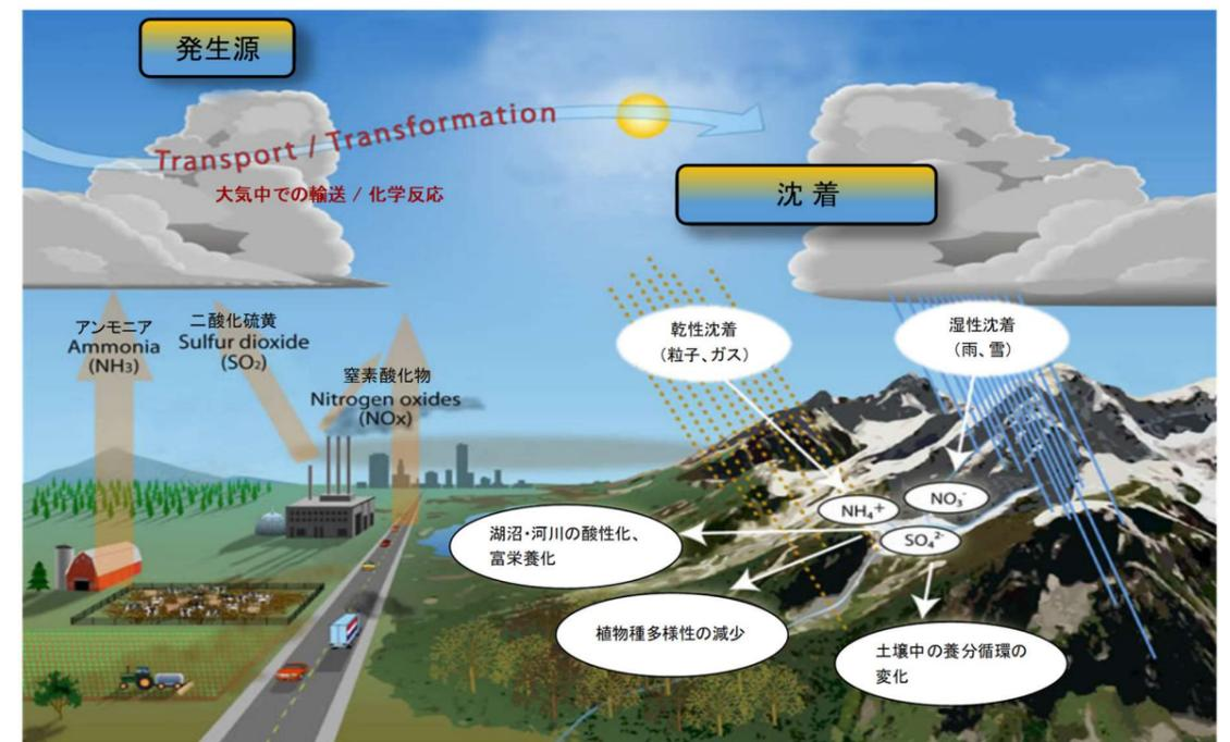
図 2: 排出、大気中の輸送と変質、雲への取り込み、乾性・湿性沈着及び環境への影響を示す大気汚染の概略図
